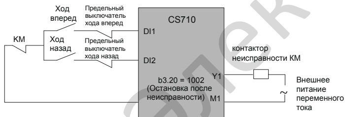
Рис. 5-10. Контур ограничителей безопасности и остановки после неисправности
